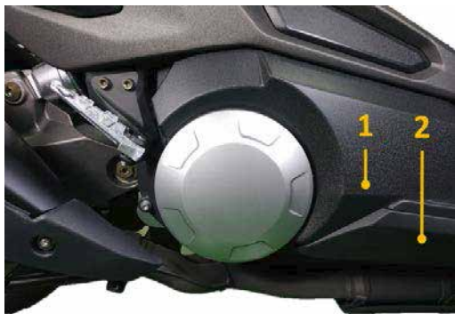
1: Pravý kryt kľukovej skrine 2: Bočný pravý kryt
